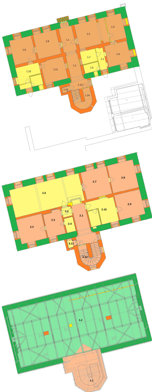
Obr. 05: Hluboš čp. 2, vyhodnocení stavebního vývoje, nahoře půdorys přízemí, uprostřed půdorys patra, dole půdorys podkroví, autor A. Kratochvílová. (citace v pozn. XX).
